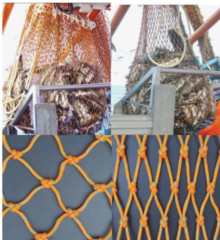
Рисунок 2 – Сетка Polytit COMPACT: слева – сетка повернута на 90° (T90n91); справа – сетка применяется в нормальном направлении (T0n44)
