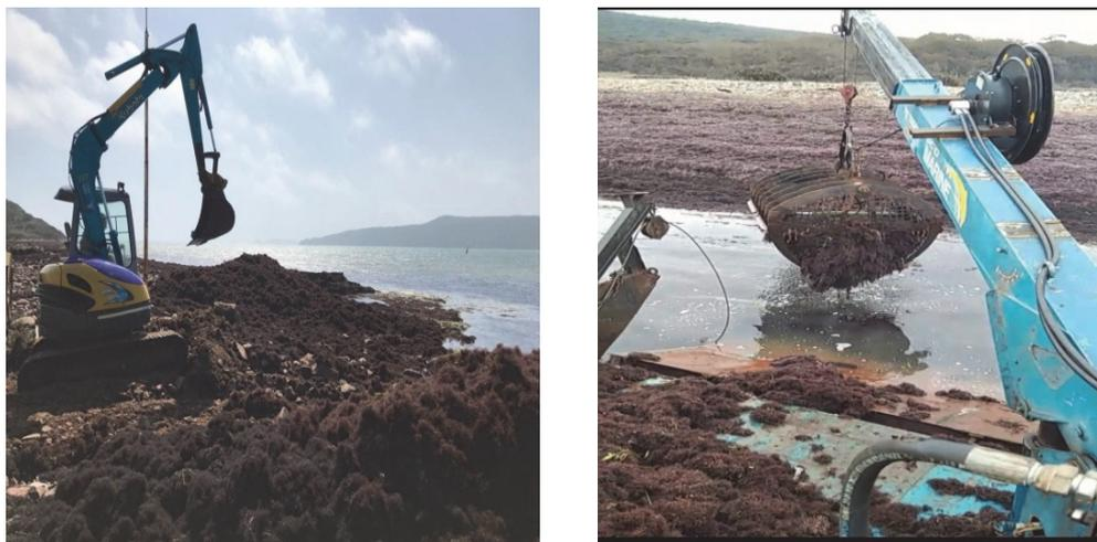
Рисунок 2 – Механизация сбора штормовых выбросов анфельции в прибрежье о. Русский (пролив Старка)
